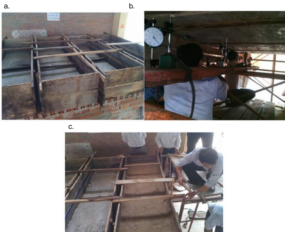
Hình 2. Lắp đặt hộc gỗ chứa cát (a); đồng hồ đo độ võng tại giữa nhịp (b) và gia tải cát theo từng cấp tải trọng (c)
